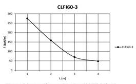
Werte aus Belastungsprüfungen nach der Norm IEC 61537, Prüftyp III. Verbindung auf 1/5xL von erster und letzter Stütze, Endspannweite = 0.8xL, 4xBN08-16
