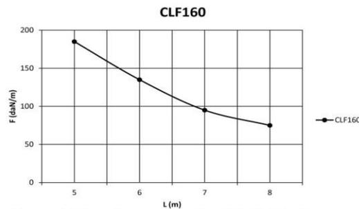
Werte aus Belastungsprüfungen nach der Norm IEC 61537, Prüftyp II.
