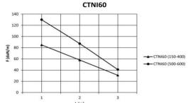
Werte aus Belastungsprüfungen nach der Norm IEC 61537, Prüftyp III. Verbindung auf 1/5xL von erster und letzter Stütze, Endspannweite = 0.8xL, 4xBNO6-10-EG
