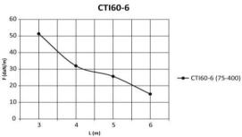
Werte aus Belastungsprüfungen nach der Norm IEC 61537, Prüftyp II. Keine Verbindung bei erster und letzter Überspannung, Endspannweite = 0.8xL, 5xBN06-10-EG
