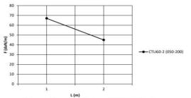
Werte aus Belastungsprüfungen nach der Norm IEC 61537, Prüftyp III. Verbindung auf 1/5xL von erster und letzter Stütze, Endspannweite = 0.8xL, 5xBN06-10-EG
