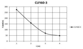
Werte aus Belastungsprüfungen nach der Norm IEC 61537, Prüftyp III. Verbindung auf 1/5xL von erster und letzter Stütze, Endspannweite = 6 4xBN08-16
