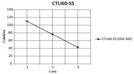
Werte aus Belastungsprüfungen nach der Norm IEC 61537, Prüftyp III Verbindung auf 1/5xL von erster und letzter Stütze, Endspannweite = 0.8xL, 5xBN06-10-SS
